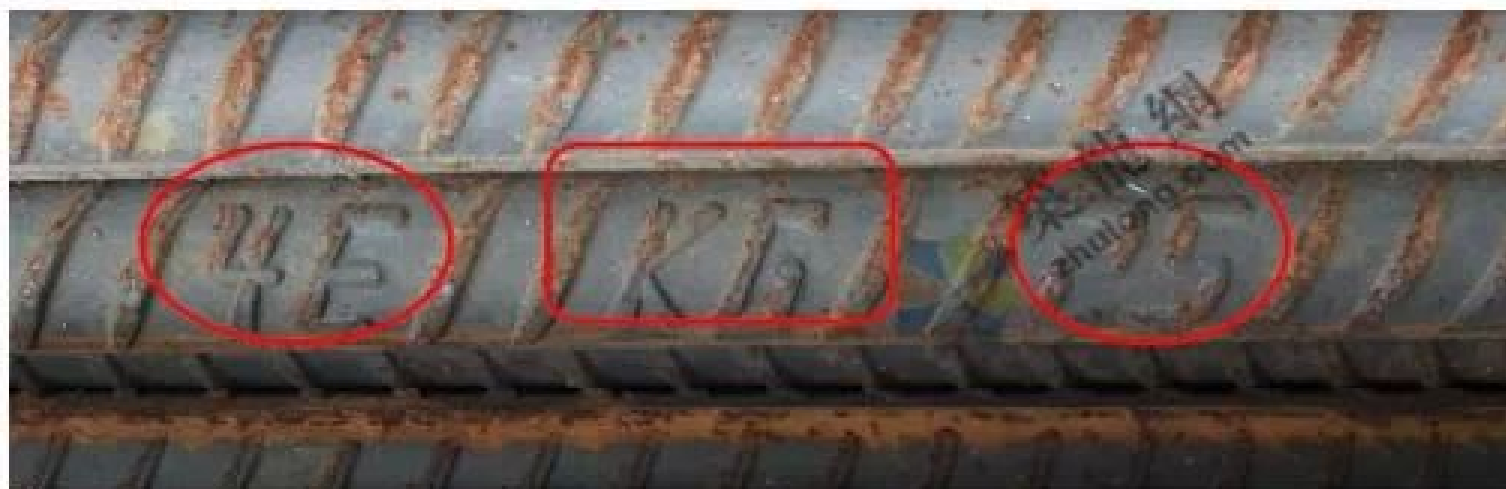
抗震钢筋 HRB400E 昆钢（ KG ） 直径 25mm
