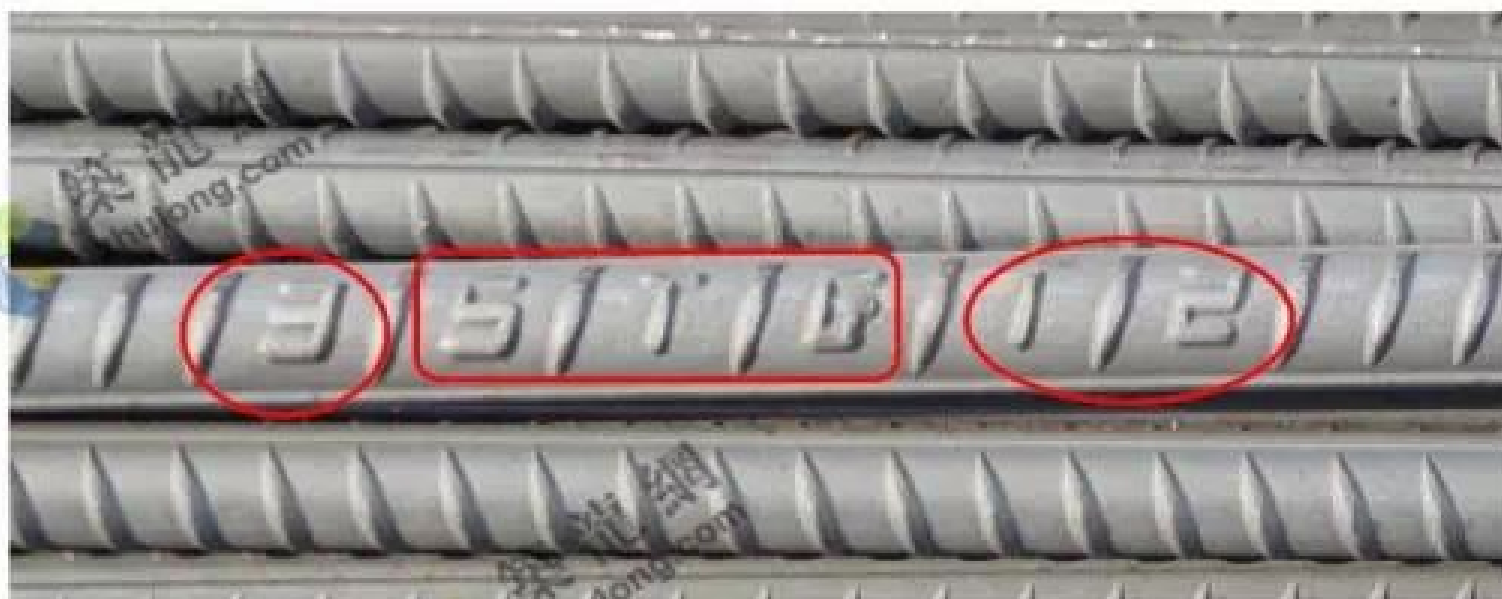
热轧钢筋 HRB335 山东肥城钢厂 STG 直径 12mm
